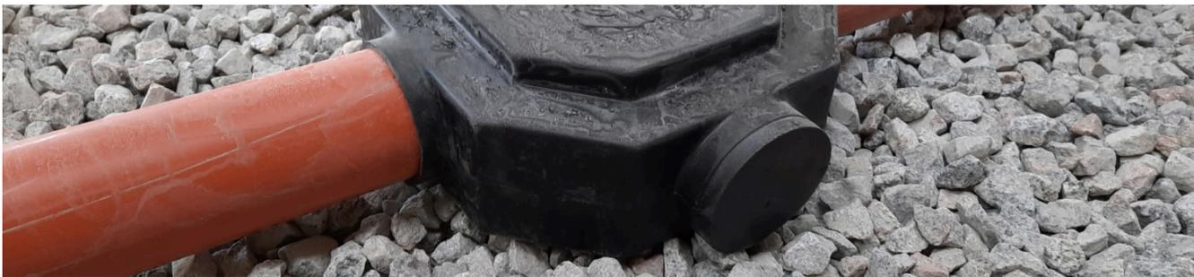
O sistema é composto por caixas (Easi-Sump), instaladas abaixo da laje de ensoleiramento do edifício, numa camada de enchimento granular para promover a circulação do gás. Esta rede é ligada por tubo de PVC a um elemento exterior (Cap-Link), para que o gás radão seja transportado para o exterior do edifício.
