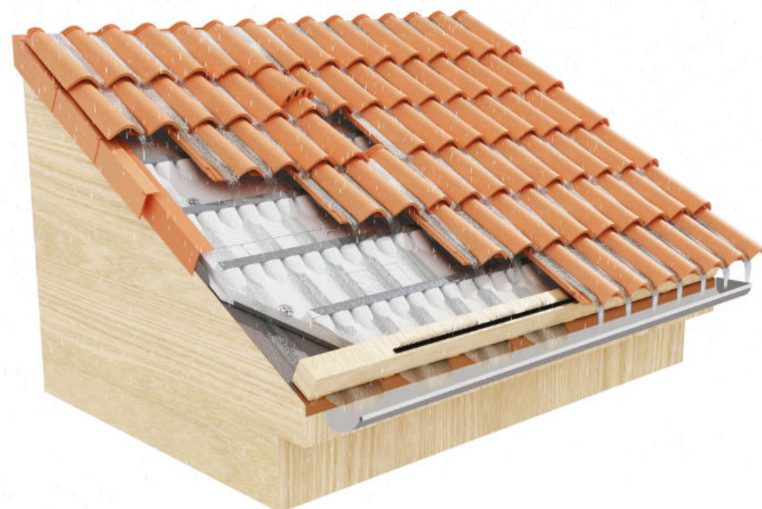
POSSÍVEL INSTALAÇÃO DE CALEIRA (ALGEROZ)
