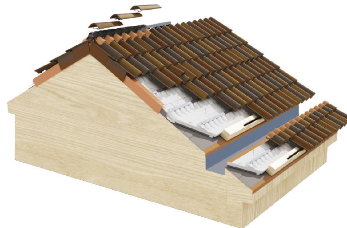
POSSÍVEL INSTALAÇÃO DE CALEIRA EMBUTIDA
