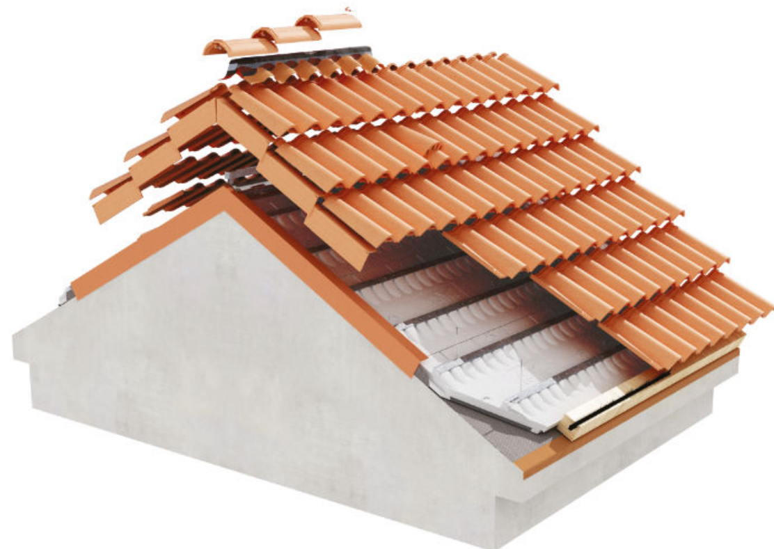
POSSÍVEL INSTALAÇÃO DE CALEIRA (ALGEROZ)
