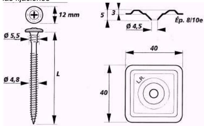
La longitud (L) de la fijación puede ser 65-75-80-90-100-110-120-130-140-150-160-180-200-220-240-260 mm. El tornillo está hecho con acero con un tratamiento anticorrosión 2C. La arandela está hecha de acero con una protección de aluminio zinc, 8/10e (mm).
