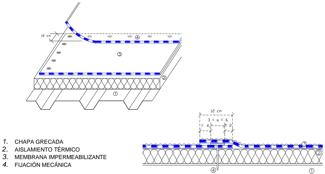
**Fig. 2** Detalle de una junta estructural
