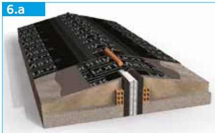
Aplicação da banda de acabamento (superior)
