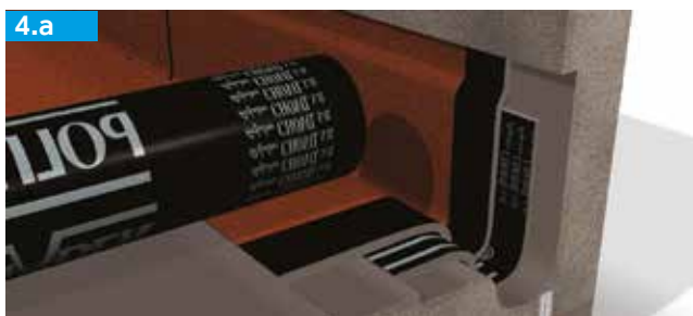
Peças de acabamento interior; membrana impermeabilizante
