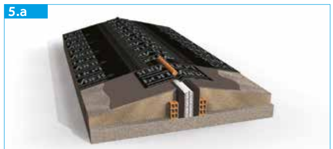
Aplicação da banda de acabamento (superior)
