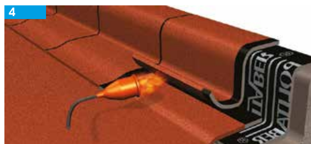
4 Aplicar membrana (dupla camada autoprottegida)
