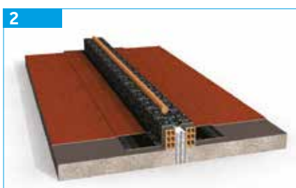
Preenchimento da junta
