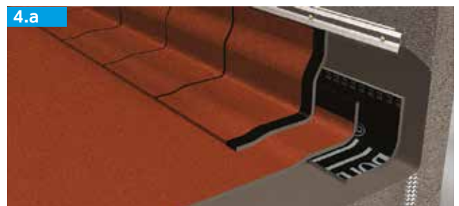
Aplicação do perfil metálico
