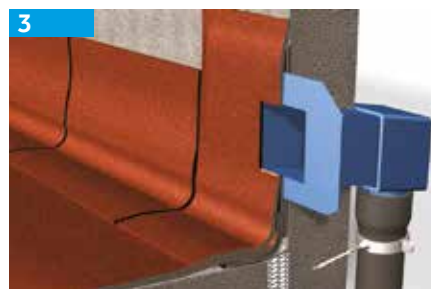
Aplicar peça de ajuste ao tubo de queda
