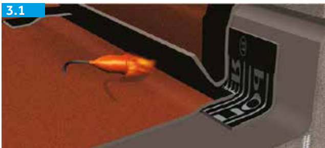
Aplicação de peças de acabamento: Membrana monocamada
