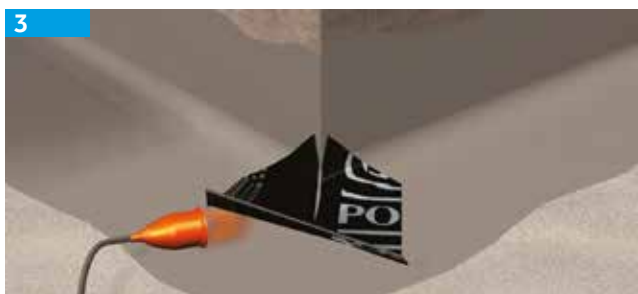
Aplicação da peça de reforço interior. Totalmente aderida
