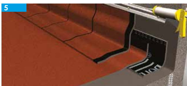
Selar o perfil no ponto de encontro com a parede
