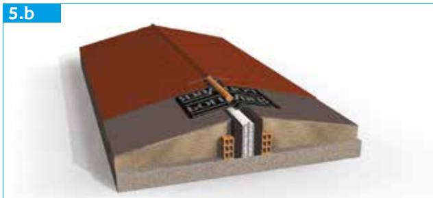
Aplicação da banda de acabamento (superior)
