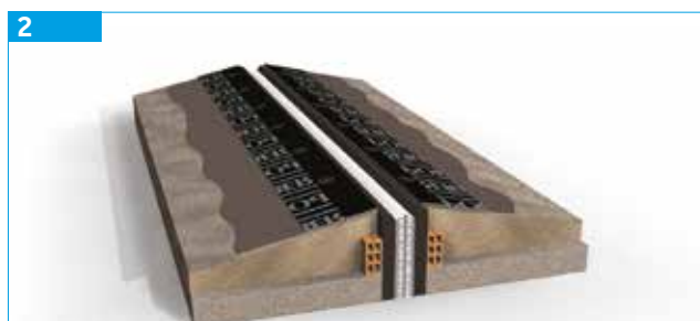
Aplicação das bandas de reforço inferiores. E material de enchimento das juntas
