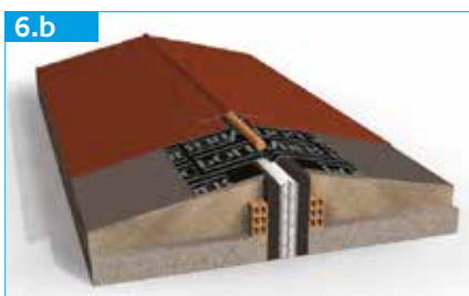
Aplicação da banda de acabamento (superior)
