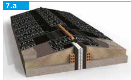
Aplicação da banda de acabamento (superior)
