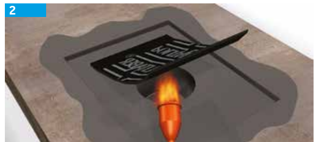
2 Soldar a peça de reforço inferior.
