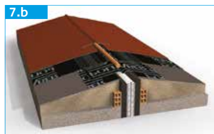
Aplicação da banda de acabamento (superior)
