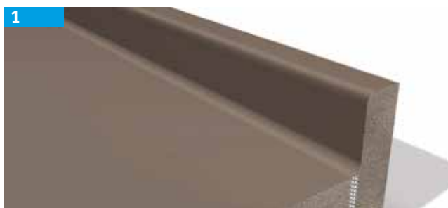
1 Murete com primário
