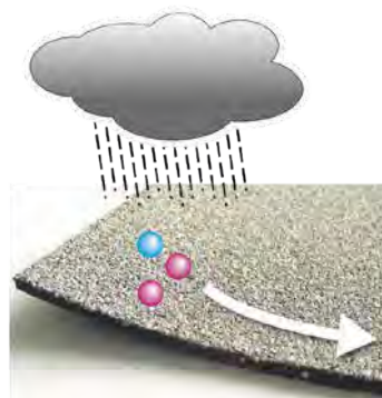
Evacuação pelas águas pluviais
