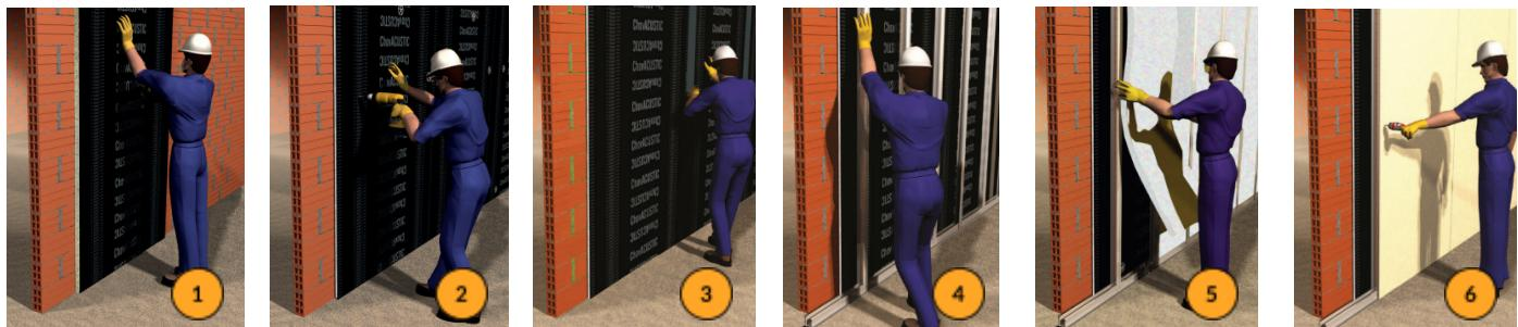
1. Verificar se a divisória não apresenta buracos ou fissuras. Caso existam, é conveniente preenchê-los com argamassa. Cortar um pedaço de ChovACUSTIC 65 FIELTEX com comprimento igual à altura da divisória. Apoiar o ChovACUSTIC 65 FIELTEX sobre a divisória, deixando a tela viscoelástica à vista.
