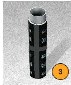
1. Cortar um pedaço de **ELASTOBAND BAJANTES** de acordo com o comprimento do tubo de queda utilizando um x-ato. Retirar o plástico antiaderente e aplicar o material, deixando a folha viscoelástica à vista. Não é necessário fixar o material com braçadeiras, pois o produto tem uma excelente aderência.
